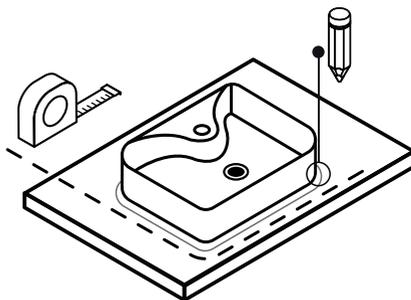
**Observação:** Se atente para que esta abertura não ultrapasse a área demarcada da cuba, de modo que o vão não fique aparente. Passagem dos flexíveis na região correspondente à mesa dos metais.
