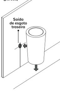
**Observação:** Antes da instalação, verifique se o piso está limpo e nivelado. Caso identifique desníveis, corrija-os adequadamente. Em seguida, alinhe o centro da válvula com a saída de esgoto da cuba, garantindo um encaixe preciso e seguro.
