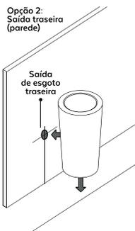
**Observação:** Antes da instalação, verifique se o piso está limpo e nivelado. Caso identifique desníveis, corrija-os adequadamente. Em seguida, alinhe o centro da válvula com a saída de esgoto da cuba, garantindo um encaixe preciso e seguro.
