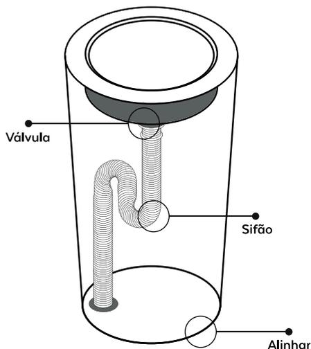
**Observação:** A válvula possui rosca de 1/4" (não inclusa). Nesta etapa, não aperte completamente as conexões, permitindo ajustes durante o posicionamento da cuba.
